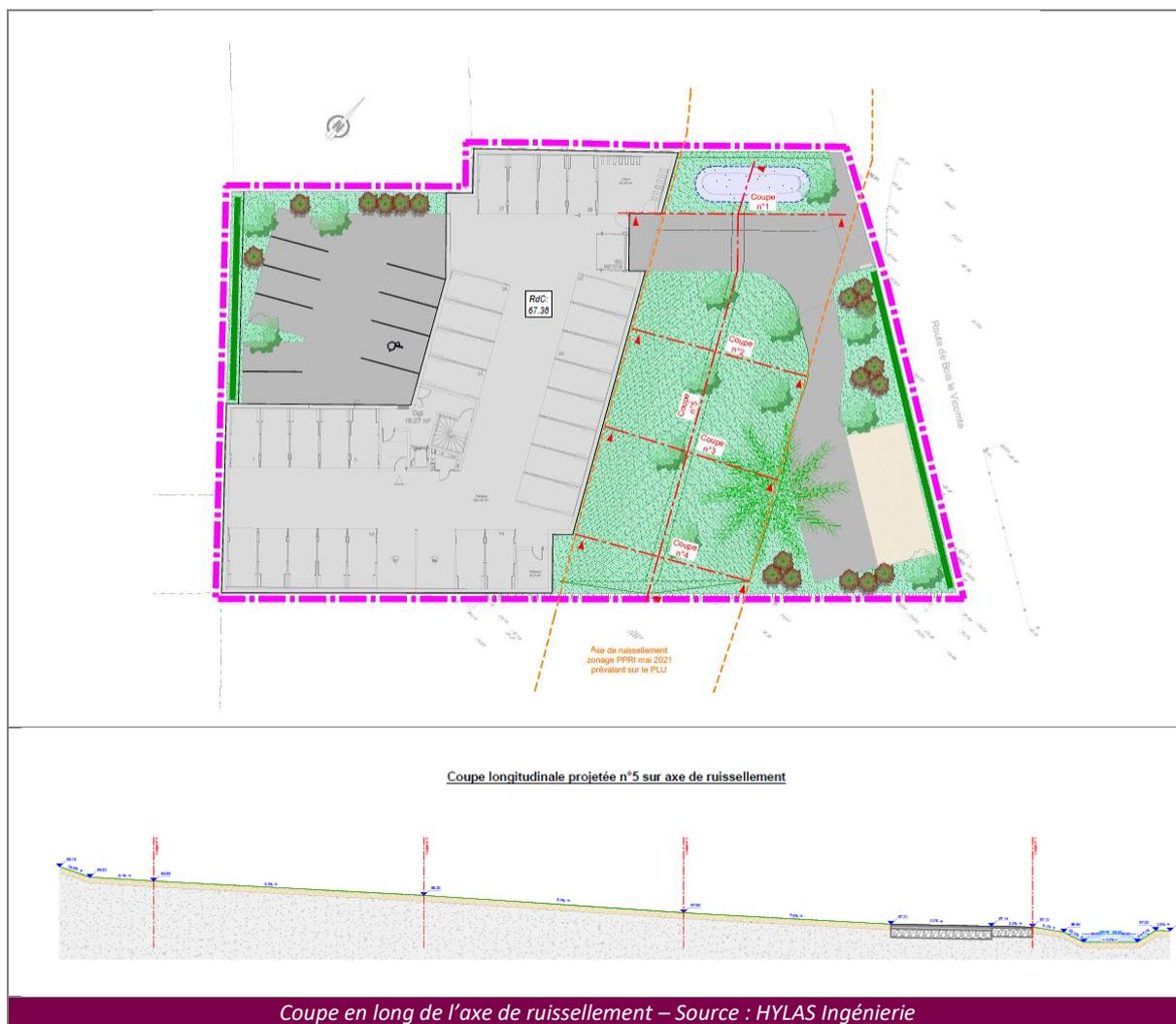
Cette coupe montre le transit des eaux issues du bassin versant amont, la voirie étant au même niveau que le modelage en cuvette, les eaux transiteront sans soucis au droit de celle-ci. De plus, des arbres seront plantés au droit des cuvettes permettant ainsi de compenser les risques d'accélération.
